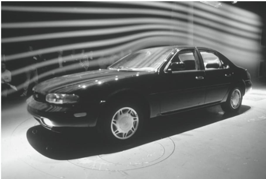
Figura 19: Fluxo de ar laminar em torno de um carro em um túnel de vento. Fonte: Knight (2009, p. 41).
